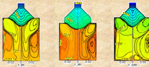
Рис.6. Рассчитанная форма ФК для \text{Bi}_{12}\text{GeO}_{20} , температурные поля в расплаве и кристалле, линии тока в расплаве
